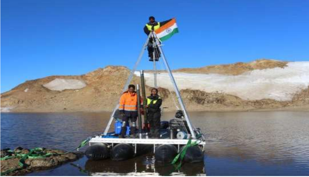
चित्र 4.2 अंटार्कटिका के लिए 41वें भारतीय वैज्ञानिक अभियान के दौरान UWITEC प्लेटफॉर्म पर VibeCoreD4 कोरर का उपयोग करके डिस्कसन लेक ब्रोकनेस प्रायद्वीप (पूर्वी अंटार्कटिका) से दो तलछट कोर की पुनर्प्राप्ति।
