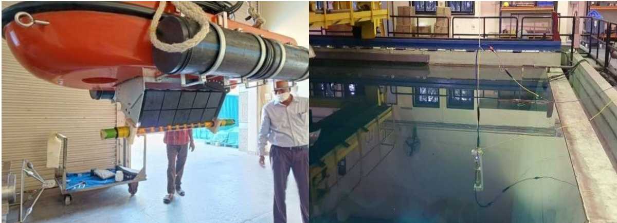
चित्र 3.17 (क) असेम्बेल्ड प्रोटोटाइप i-SASSS A (ख) ATF परीक्षणों के दौरान डिजिटल हाइड्रोफोन ऐरे
