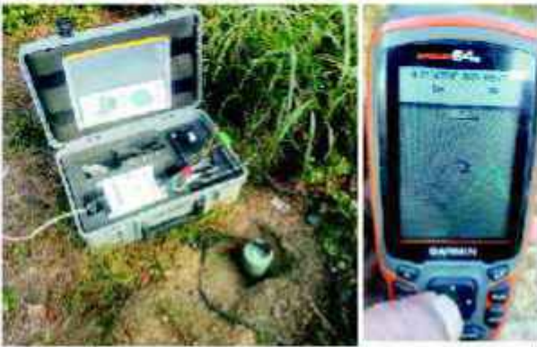
चित्र 5.4 : आगरा शहर में विशिष्ट माइक्रोट्रेमर सर्वेक्षण उपकरणन की स्थापना
