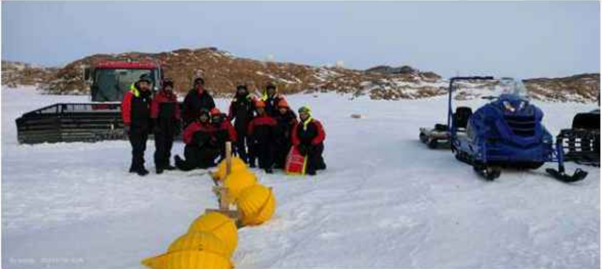
चित्र 4.9 जुलाई 2023 में भारती स्टेशन (69°24'S, 76°12'E), प्रिड्ज खाड़ी के पास आइस टेथर्ड मूरिंग की तैनाती। यह मूरिंग प्रणाली ऑस्ट्रल सर्दियों के दौरान 120 मीटर गहराई के जल स्तंभ में तापमान, लवणता और समुद्री धाराओं को मापेगी।
