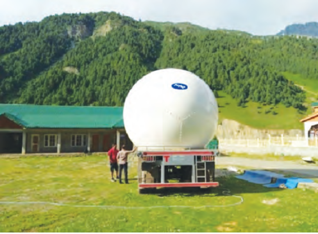
चित्र 2.1 सोनमार्ग में मोबाइल प्लेटफॉर्म पर एक पोर्टेबल एक्सबैंड डॉपलर वेदर राडार
