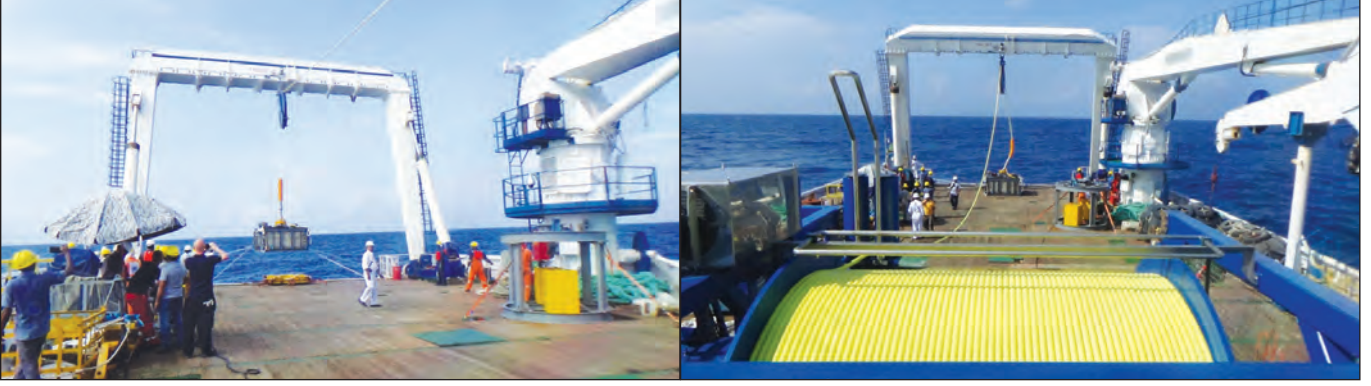
चित्र 3.11 ऑन-बोर्ड ओआरवीसागरनिधिपर विंचऔर गर्भनाल केबल का परीक्षण
