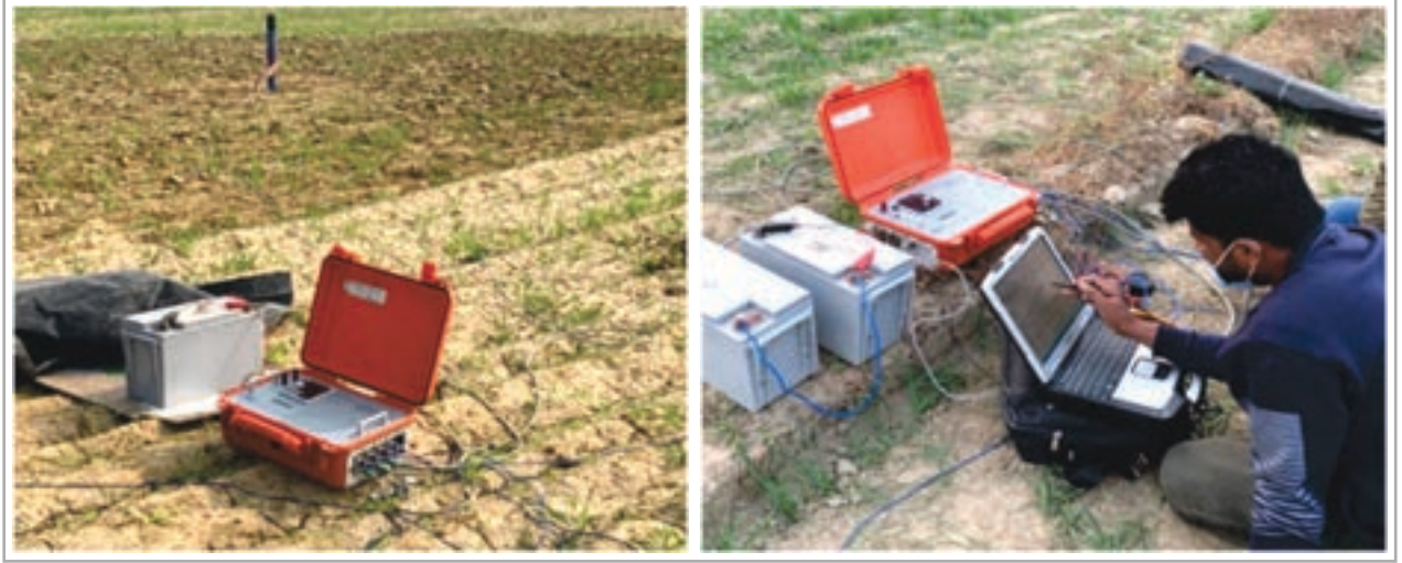
चित्र 5.5 (क): एक प्रतिरूपी एमटी के फोटोग्राफ तथा क्षेत्र में डेटा रिकॉर्ड करने के लिए एमटी उपकरणों का क्षेत्र सैट अप
